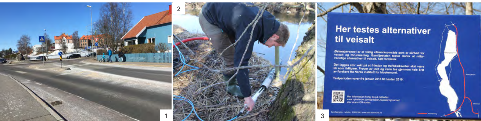
1) Det hvite belegget i Østensjøveien skyldes formiat fra prosjektet for miljøvennlig salting. Foto: 02.04.2018. 2) Prøvetakingsinstrumentet senkes ned i bekken og samler inn data fra vannet, her ved Bølerbekken. Fra instrumentet overføres resultatene via kabel til en stasjon som periodisk viderefører til NIBIO for analyse. Foto: 12.04.2018. 3) Skilt ble satt opp for å vise hvilke strekninger som ble strødd med formiat. Foto: 02.04.2018.
