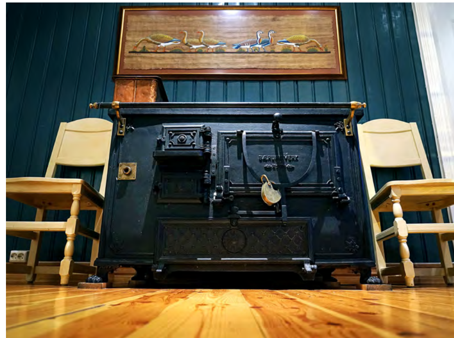
Minna hadde et teknisk vidunder å lage mat på. En vedkomfyr fra Bærums Verk med stekeovn, seks kokehull og varmtvannstank og flere brennkamre. Foto: Marius Wærhaug Madsen.
